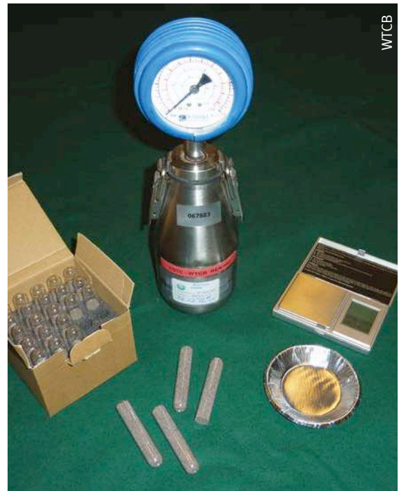
Afb. 2 De carbidefles: nauwkeuriger, maar moeilijker te gebruiken.
